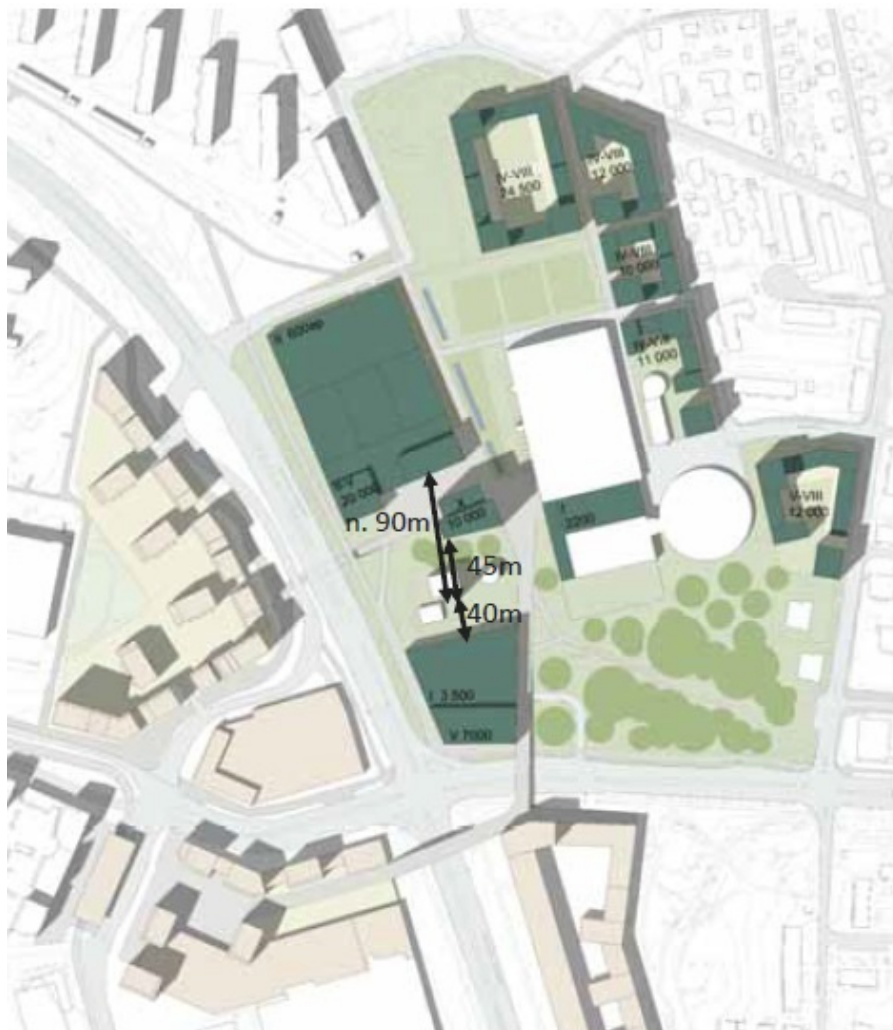
Kuva 2. Voimalan pohjoispuolella on yksi mahdollinen asuin- tai majoitusrakennuksen sijainti suunnittelualueella. Voimalan eteläpuolelle on tässä hahmoteltu urheilu- ja liiketiloja. Etäisyydet arvioitu lämpökeskuksen piipuista.
